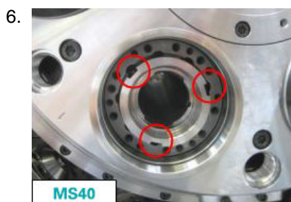
Exemple : Position du manchon MS40
