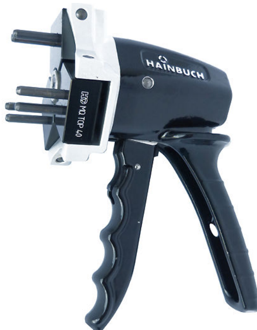
Exemple : Système de changement de pinces (Hainbuch)
