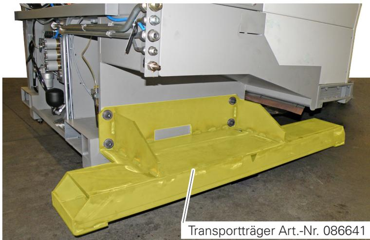
**i** Es muss darauf geachtet werden, dass der Transportträger Artikel-Nr. 086641 bei der Montage die Maschine richtig untergreift.
